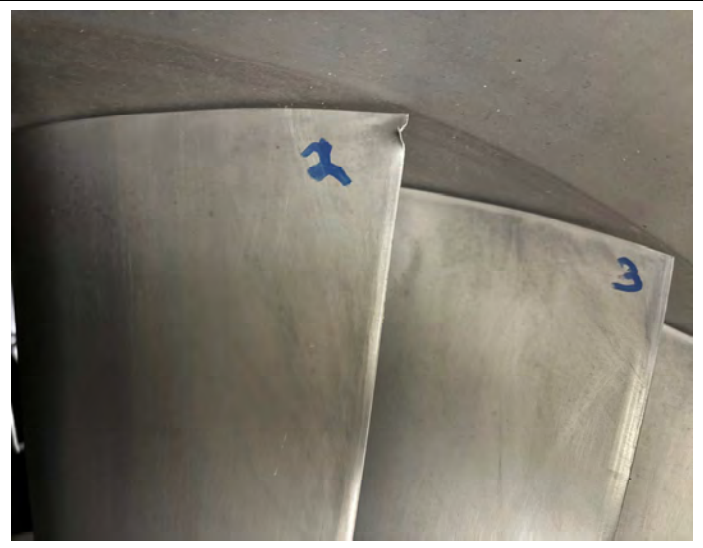
Fan Blade with FOD - Unserviceable
